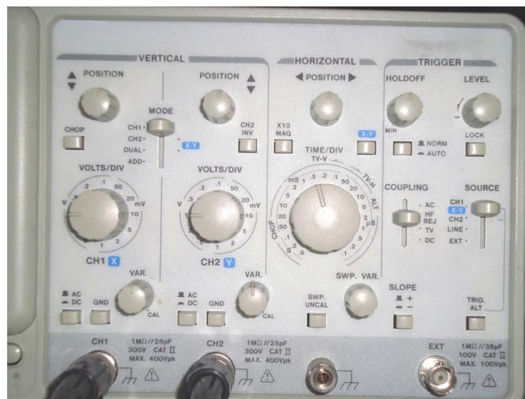
Figura 2. Bloque de control del osciloscopio analógico utilizado en el Laboratorio.
